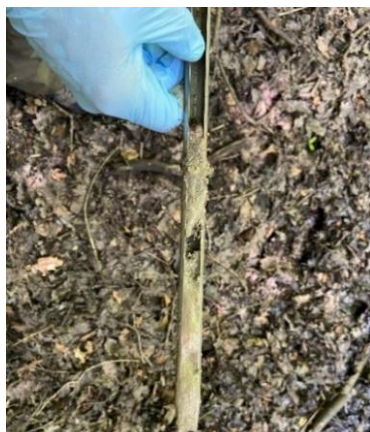
Photographie 7. Test d'argile à la tarière – Forêt de Rambouillet (Île de France). ©Timothé Courteille / Office Français de la Biodiversité.
