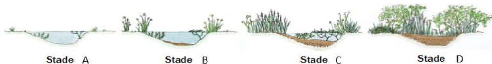
Figure 11. Les quatre stades du processus d'atterrissement d'une mare. Modifié de Abe-Goulier et al., 2019.
