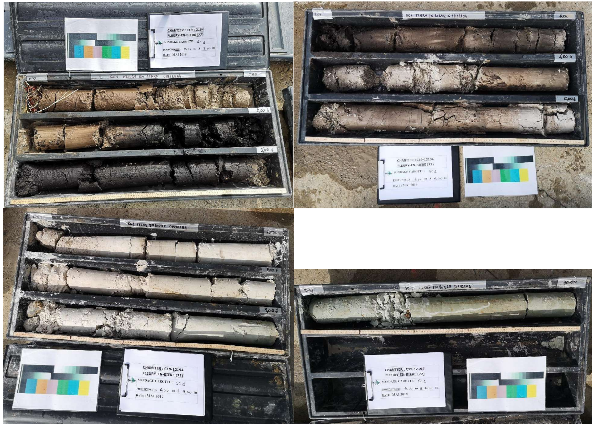
Figure 37 – Reconstitution du profil géologique par succession de carotte de 1 mètres, Sémofi le 12/04/2019
