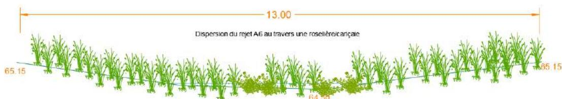
Figure 20 - Schéma de principe de l'aménagement prévu en aval du rejet de l'A6
