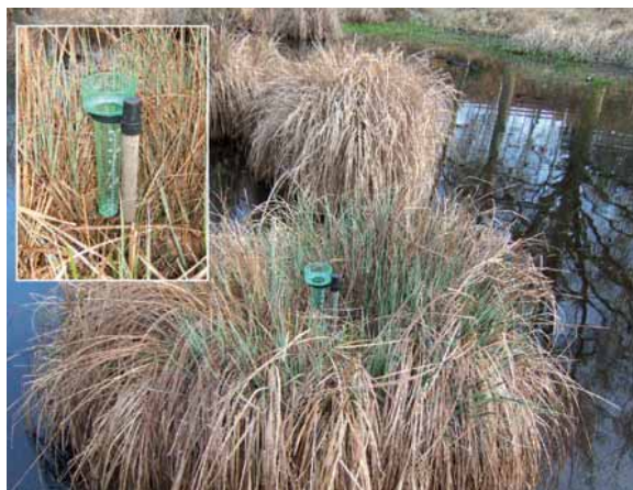
Petit pluviomètre en plastique : ce matériel a une faible autonomie et reste fragile au gel. Il permet néanmoins d'équiper facilement et rapidement plusieurs mares
