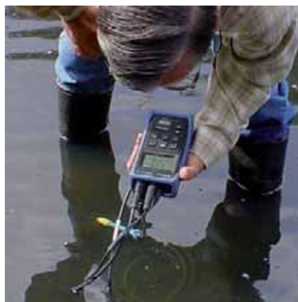
Appareillage de prises de mesures fines de pH, oxygène, température, conductivité et salinité
