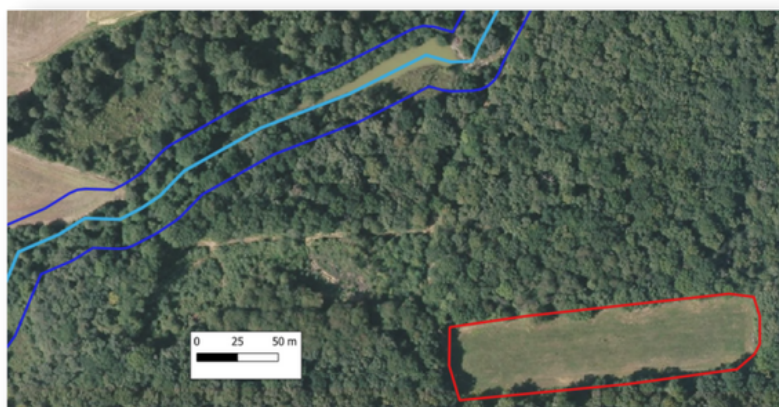
Exemple d'un buffer autour d'une rivière de rang Strahler 2 - Capture d'écran QGIS
