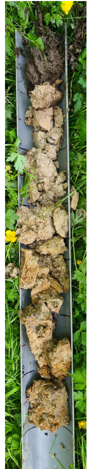
Exemple d'un sondage à la tarière
