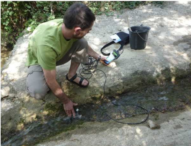
FIGURE 3.1 - Jaugeage conductimétrique d'un cours d'eau dans le département de la Drôme - Août 2009
