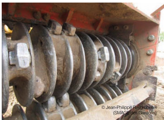
Rotor pour broyer les renouées
