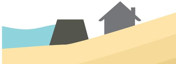
Murs, perrés et digues peuvent être accompagnés de protection de pied pour réduire l'affouillement et d'un couronnement destiné à limiter la projection de paquets de mer dans la zone protégée.
