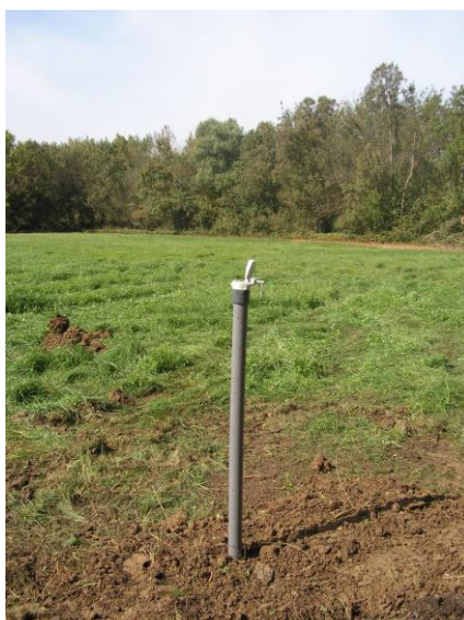
Figure 12 : Piézomètre installé sur une prairie humide en Saône-et-Loire (A. ARDOUIN, CENB)
