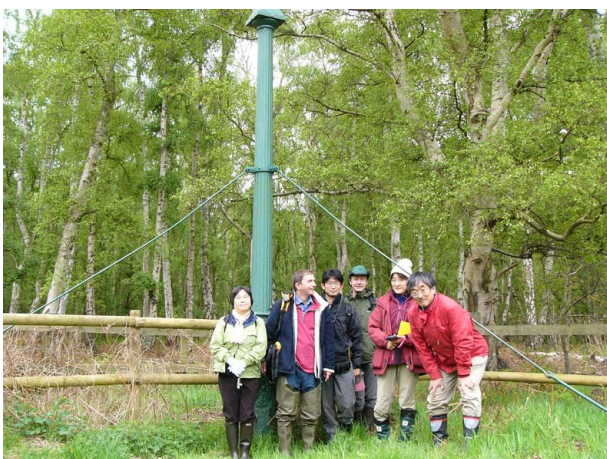
Photo 19 - Illustration du phénomène de minéralisation et de subsidence de la tourbe : avant drainage du site, le sommet du poteau se trouvait à la surface du sol de la tourbière (© R. Lindsay)
