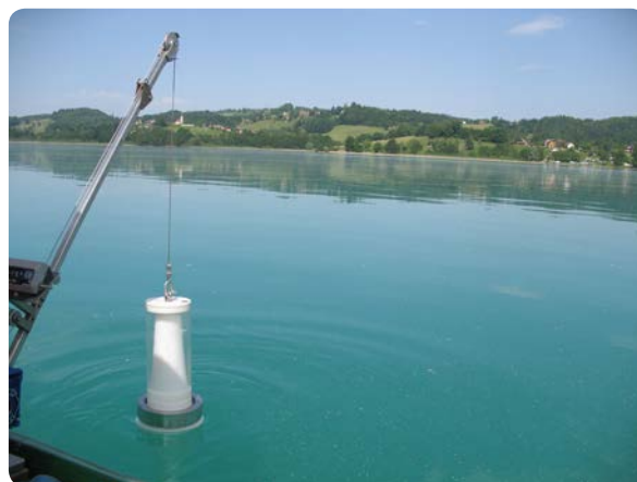
Prélèvement intégré à l'aide d'une bouteille de type « Pelletier »
