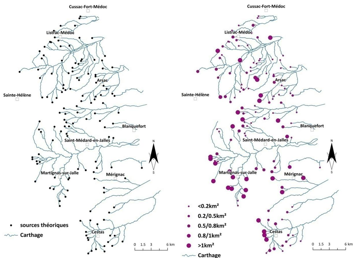
Figure 16 - Réseau utilisé pour la modélisation et "sources théoriques" visant à tester les surfaces d'initiation. A gauche, le réseau modifié avec les points "sources théoriques". A droite, répartition spatiale des surfaces drainées par chaque source théorique.
