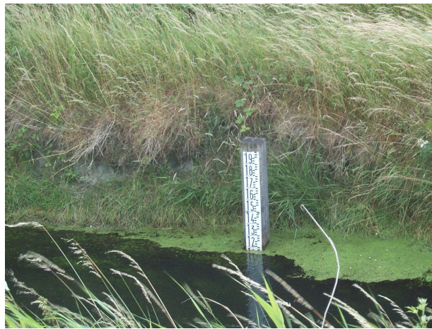
Figure 72 : une échelle limnimétrique dans un fossé
