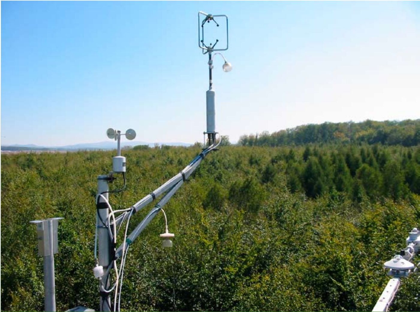
Mesure des flux d'eau et de CO 2 au-dessus d'une hêtraie (Forêt Domaniale de Hesse - Moselle) au moyen de la méthode des corrélations turbulentes. © INRA
