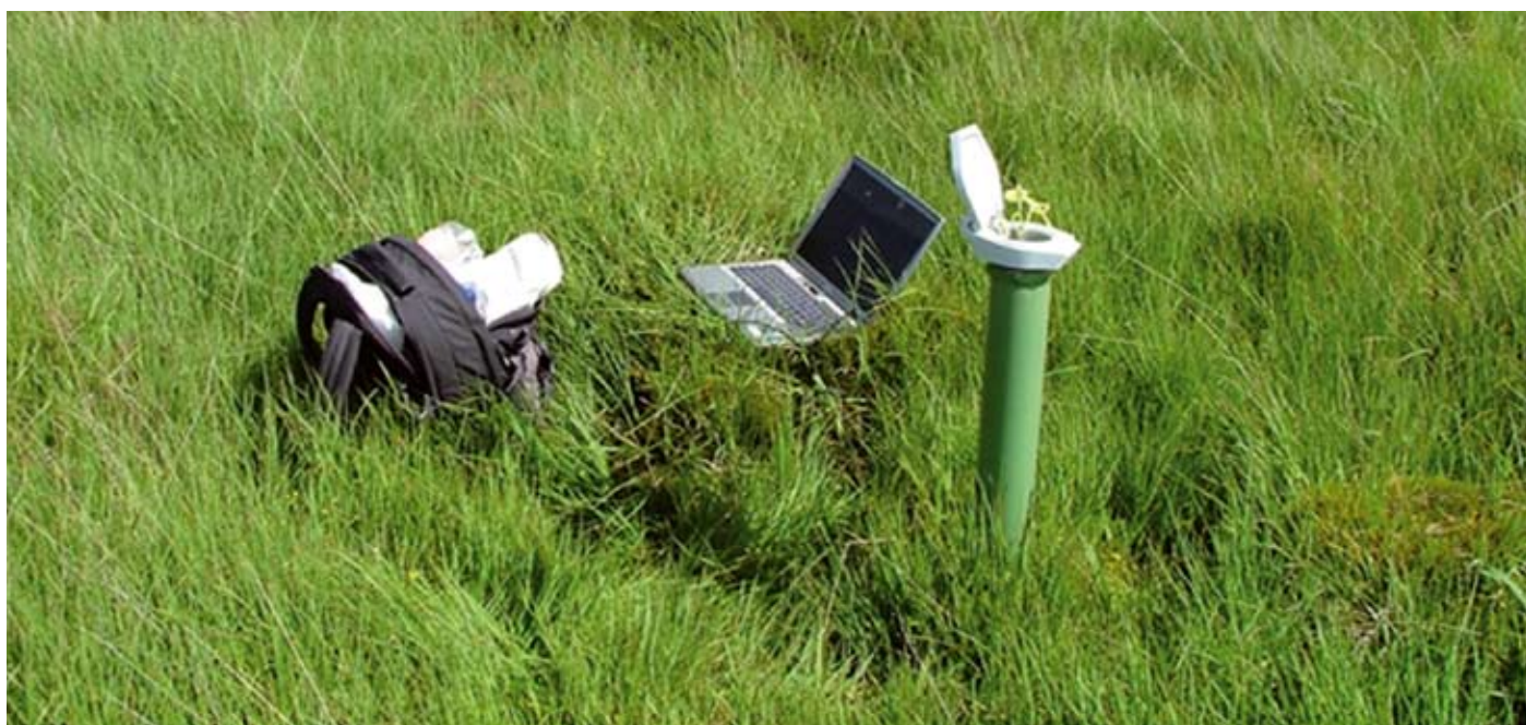
Un piézomètre équipé d'enregistreur à la Tourbière de la Verrerie. Commune de Burzet, Ardèche. © Fabrice Grégoire
