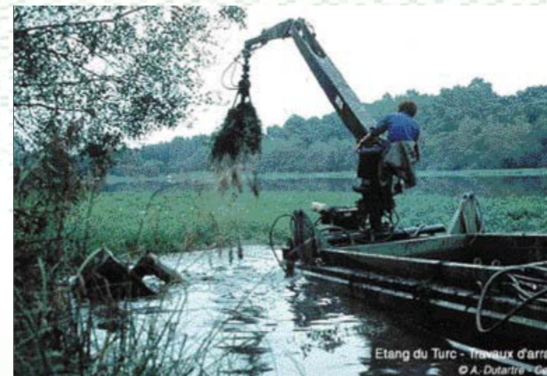
Contrôle de la végétation des étangs landais par arrachage mécanique. Une griffe preneuse située au bout d'un bras hydraulique porté par une barge permet d'arracher les végétaux qui sont ensuite déposés dans la barge. Photo A Dutartre. CEMA - GREF (Bordeaux).
