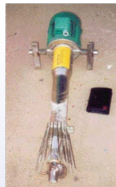
Aérateur à injection d'air utilisé à Apt (ARM Technology)
