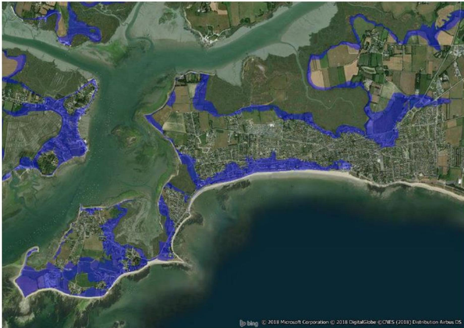
**Fig. 36. Enveloppe de submersion T100, avec changement climatique**
