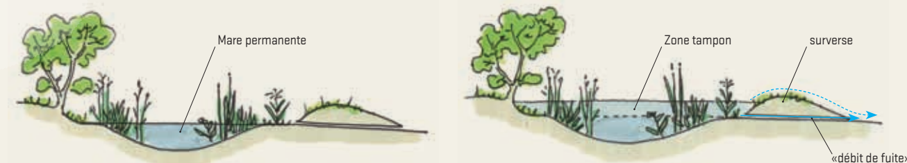
Schémas du fonctionnement hydraulique d'une mare tampon
