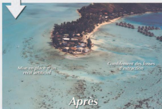
2. **Mise en place de blocs artificiels en béton** : Fonction de brise-lame des houles lagonaires (limite l'érosion du littoral). Les blocs artificiels ont été conçus pour simuler (forme, couleur, aspérités, cavités) de gros massifs coralliens naturels et pour conserver l'esthétique du site. Les blocs ont été disposés seuls ou en groupe de 2 ou 3 pour reconstituer des massifs dont l'agencement est le plus proche possible de celui observé dans le lagon non perturbé.
